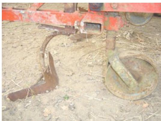
Un élément de la bineuse de précision équipé d'une lame « patte d'oie qui permet de réaliser un léger buttage
